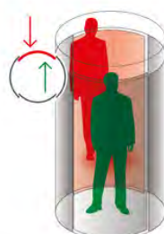
TAILGATING: IN TEGENGESTELDE RICHTING DETECTIE VIA: CONTACTMAT
