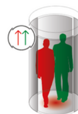
PIGGYBACKING (PASSAGE EN FRAUDE) : Détection par système de pesée et stéréovision
