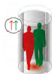
PIGGYBACKING (PASSAGE EN FRAUDE) : DÉTECTION PAR SYSTÈME DE PESÉE ET STÉRÉOVISION
