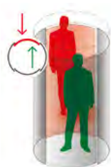
TAILGATING (TALONNAGE) : DANS LA DIRECTION OPPOSÉE DÉTECTION PAR TAPIS DE CONTACT
