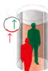
TAILGATING (TALONNAGE) : DANS LA MÊME DIRECTION DÉTECTION PAR TAPIS DE CONTACT
