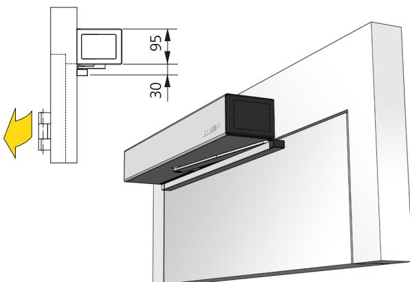
Tringles de glissement avec fonction de traction
